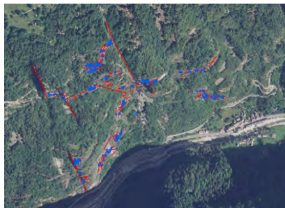
Figura 4a – Sistemi di discontinuità (linee rosse) ed intersezioni (punti in blu).
