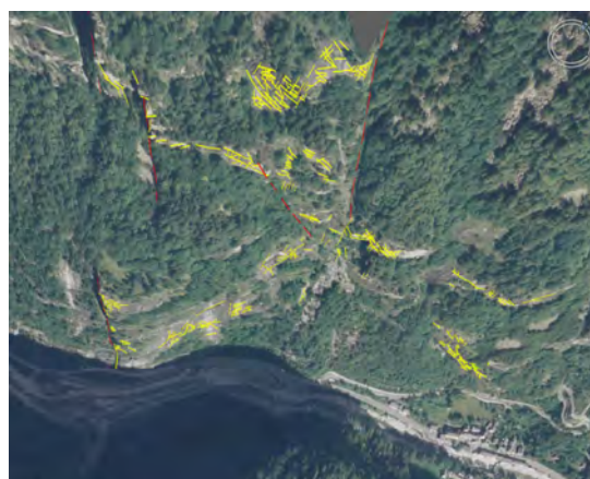
Figura 2 – Sistemi di fratture (in giallo) e faglie (in rosso)
